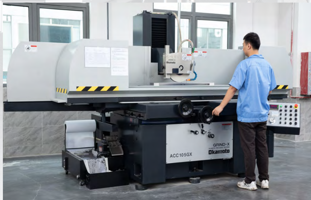
OKAMOTO 冈本平面磨床 ACC105GX 工作台行程: 1150*540
