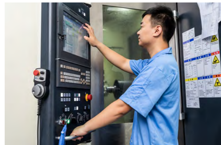
MAKINO 牧野卧式加工中心 a92 轴向行程：1520*1250*1350 X、Y、Z轴光栅反馈0.1μm
